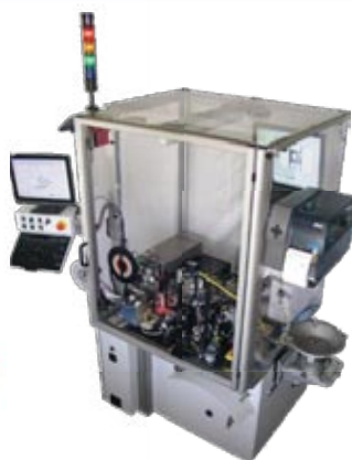
Automatická balící linka kondenzátorů
